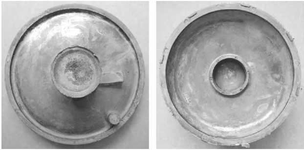
(a) 凸面 (b) 凹面 图 2 ZM5 镁合金隔板件
