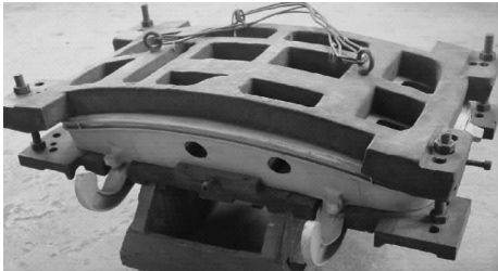
图 7 波音 737 飞机舱门铸铝件淬火工装
