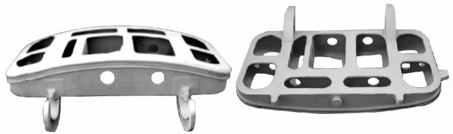
图 8 2 mm 壁厚舱门铸铝件
