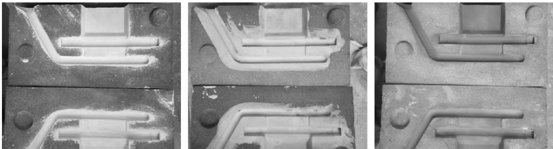
(a) 醇基锆英粉涂料涂层 (b) 醇基刚玉粉涂料涂层 (c) 醇基石英粉-石墨粉涂料涂层
