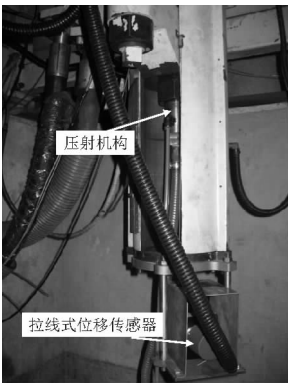
图 3 位移传感器安装示意图
