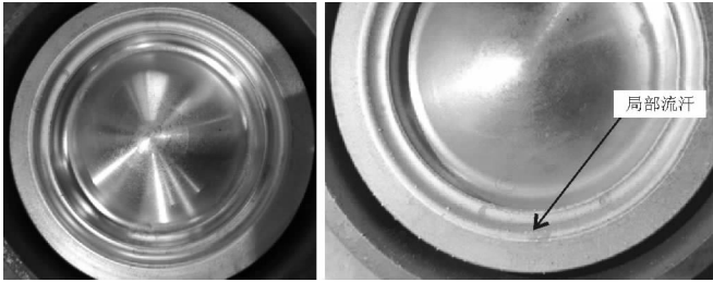
(a) 160~490 ℃热冲击 10 次后完好活塞 (b) 160~500 ℃热冲击 2 次后“流汗”活塞
