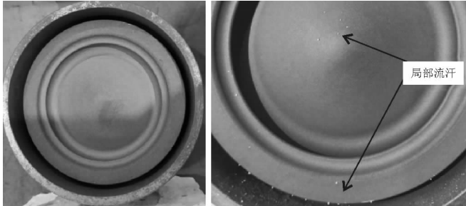
(a) 160~520 ℃热冲击 10 次后完好活塞 (b) 160~530 ℃热冲击 3 次后“流汗”活塞
