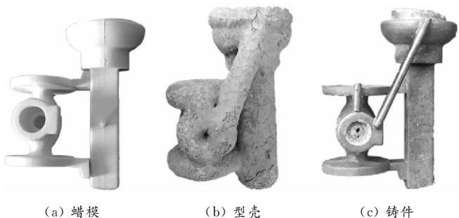
图 14 阀体铸件的生产过程 Fig.14 Casting process of valve body
