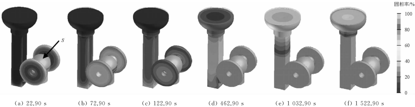
图 3 初始方案铸件凝固过程的固相分布
