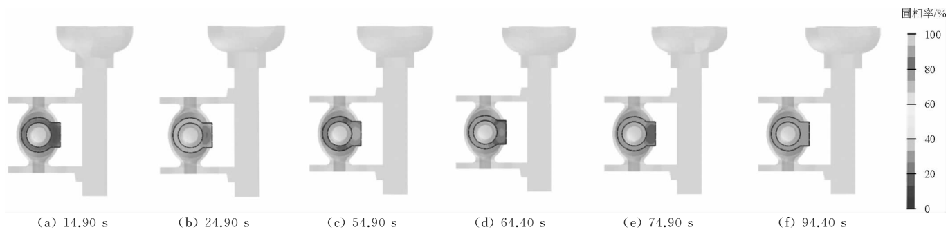
图 8 优化方案铸件 R 位置处截面凝固过程 Fig.8 Solidification process of section at R position
