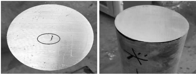
(a) 传统熔铸 (b) 半连铸 图 8 铸棒横截面形貌 Fig.8 Cross section of casting rod
