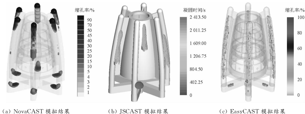
图 7 改进方案后铸件缩孔缺陷预测
