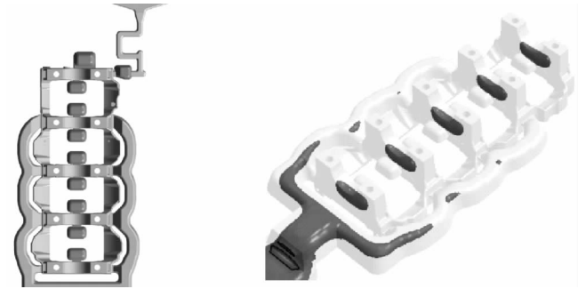
图 2 铸造方案 Fig.2 Casting scheme 图 3 模拟凝固分析 Fig.3 Simulated solidification analysis
