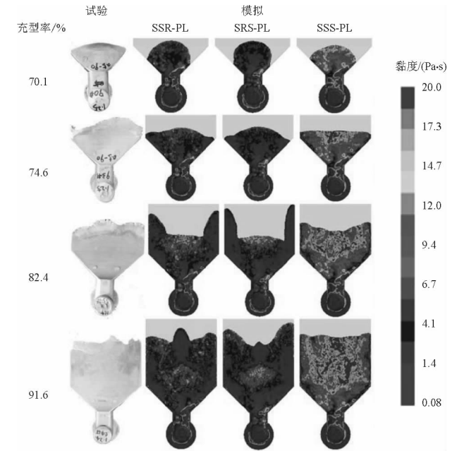
图 5 采用 SSR、SRS 和 SSS 测试拟合的幂律模型获得的模拟结果和试验结果 [39]
