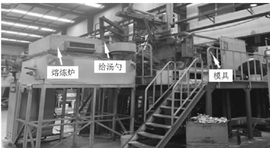
(a) 350T 半固态挤压铸造装置
