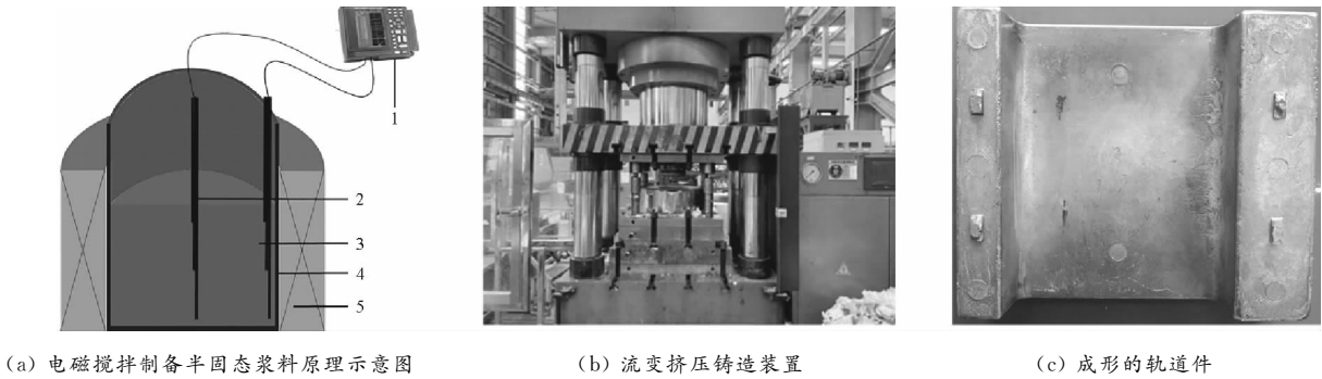
图 1 流变挤压铸造装置及轨道件实物图
