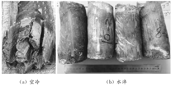
图 1 不同冷却方式下合金浆料的实物图 Fig.1 Products of alloy slurries with different cooling conditions
