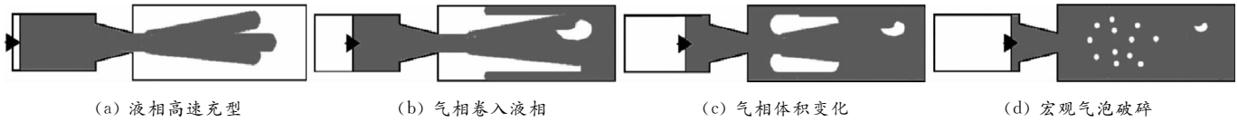
图 2 压铸充型过程中气相演变情况 [19]
