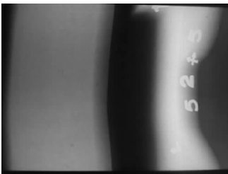
图 10 改进方案 2 铸件内部沿法兰盘与圆环相交处 X 光探伤显像
