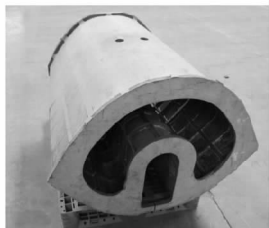
图 7 改进圆角后的铸件
