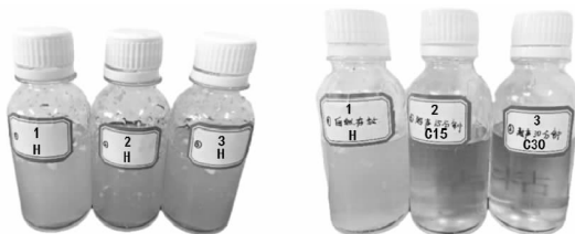
(a) 混合前 (b) 混合后 图 6 混合液超声前后试样瓶
