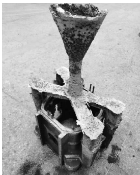
图 8 中注式浇注的基座铸件
