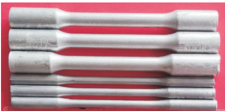
图 1 重力铸造和压铸拉伸试样 Fig.1 Tensile test specimens
