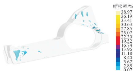
图5 铸件缩松、缩孔所在位置示意图
