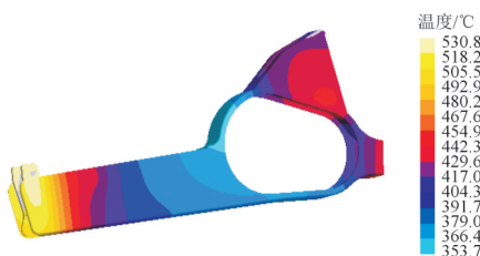
图6 铸件凝固过程温度场
