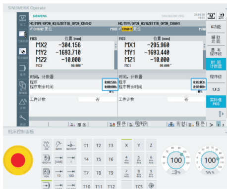
图3 SINUMERIK Operate软件模拟双五轴加工节拍图
